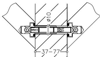
Bohrloch  $\varnothing$  10 mm
