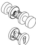
Objekt-Knopfdrückergarnituren NY.KDG..., nach DIN EN 1906 Gebrauchsklasse 2 und DIN 18255. FS-Ausführung nach DIN 18273 und DIN EN 179. aus Nylon, Farbe..., Knöpfe Ø 52 mm, mit lockerungssicherer Drückerstiftverbindung in wartungsfreien Gleitlagern, mit Stützzapfen Ø 7 mm und verdeckter, lockerungssicherer Verschraubung mit Spax-Schrauben oder mit beschichteten Hülsenschrauben bei Schildern. Knopf feststehend lieferbar.
