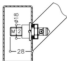
Bohrloch Ø 18 mm
