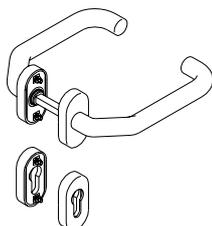
Objekt-Drückergarnitur EST.ZG... / BZG..., nach DIN EN 1906 Gebrauchsklasse 4 und DIN 18255. FS-Ausführung DIN 18273 und DIN EN 179.
