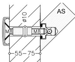
Bohrloch  $\varnothing$  10 mm
