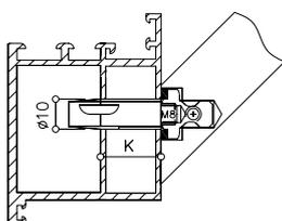
Bohrloch Ø 10 mm
