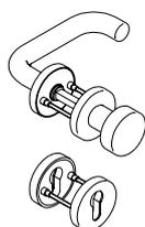
Objekt-Wechselgarnitur NY.WG..., nach DIN EN 1906 Gebrauchsklasse 3 und DIN 18255. FS-Ausführung nach DIN 18273 und DIN EN 179. Aus Nylon, Farbe..., Drücker Ø 20 mm oder Ø 23 mm, mit durchgehenden korrosionsgeschütztem Stahlkern Knopf Ø 52 mm feststehend, mit festdrehbarer Verbindung in wartungsfreien Gleitlagern, mit Stützzapfen Ø 7 mm und verdeckter, lockerungssicherer Verschraubung mit beschichteten Hülsenschrauben M4. Knopf drehbar lieferbar.
