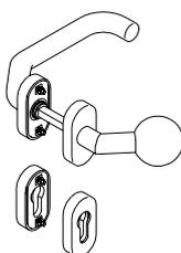
Objekt-Wechselgarnitur EST.WG..., nach DIN EN 1906 Gebrauchsklasse 4 und DIN 18255. FS-Ausführung nach DIN 18273 und DIN EN 179.
