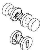
Objekt-Knopfdrückergarnitur NY.KDG..., nach DIN EN 1906 Gebrauchsklasse 3 und DIN 18255. FS-Ausführung nach DIN 18273. Aus Nylon, Farbe..., Knöpfe Ø 52 mm, mit festdrehbarer Verbindung in wartungsfreien Gleitlagern, mit Stützzapfen Ø 7 mm und verdeckter, lockerungssicherer Verschraubung mit beschichteten Hülsenschrauben M4. Knopf feststehend lieferbar.
