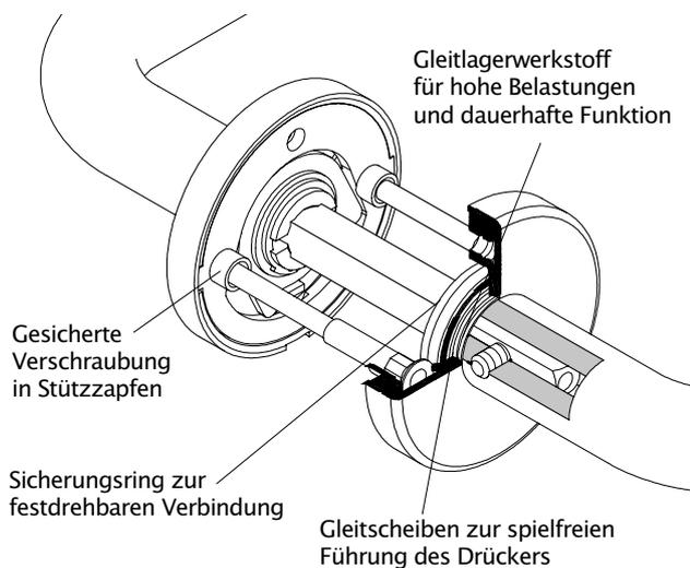
Die Drücker dieser Serien sind in Rosettenunterteilen mit wartungsfreien Gleitlagern verbunden.
