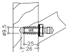
Bohrloch  $\varnothing$  9,5 mm
