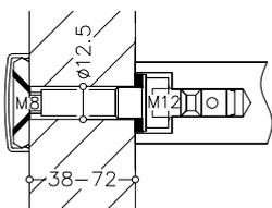
Für Befestigungsdurchmesser 26 - 32 mm:
