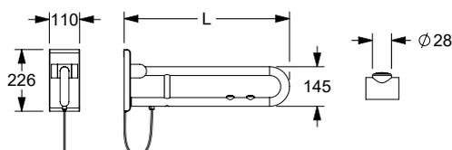
Aansluiting met montageplaat verdekt met 2 elektronische schakelaar
