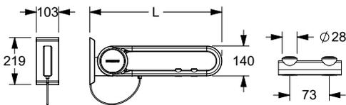
**Cavere Barre d'appui rabattable, vario, avec boutons de commande LED pour chasse d'eau et appel d'urgence Avec plaque de montage**
