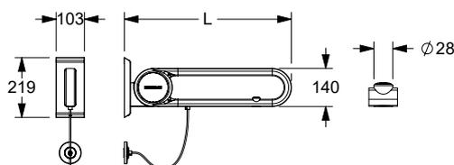
Verborgen aansluiting met rozet met 1 elektronische schakelaar
